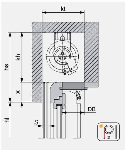
Bei Handantrieb steht die Endschiene unter dem Sturz 20 mm ins Licht.
