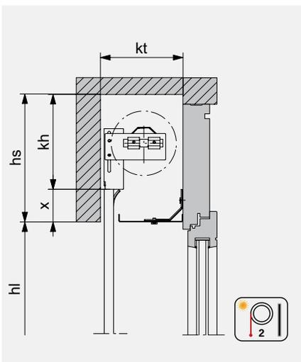
Mit Untersichtsblende. Bei Handantrieb steht die Endschiene unter dem Sturz 20 mm ins Licht.
